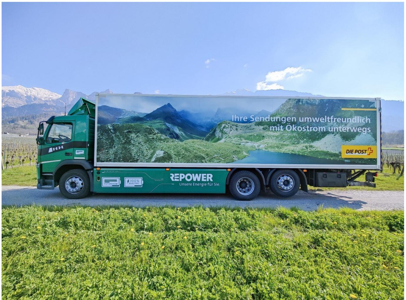
Die eingebauten Batterien des neuen Elektro-Lkw weisen eine Kapazität von 680 kWh auf.
